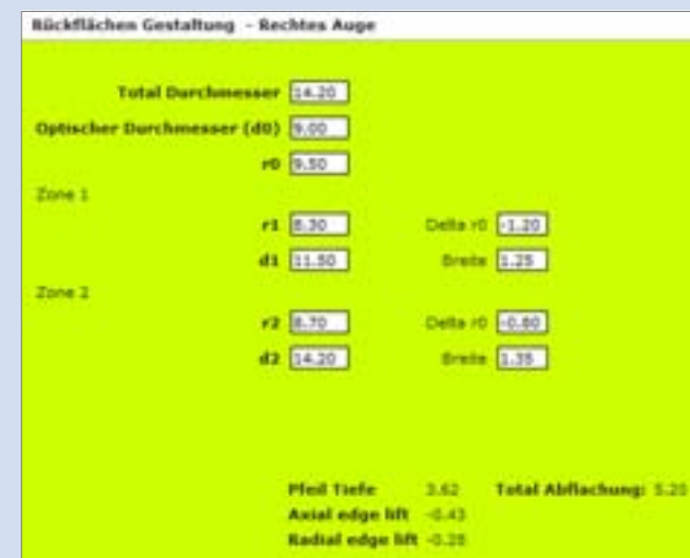
Bild 3: Online-Tool zur Flächengestaltung. Delta r0 = Differenz von r0 zum Radius; Breite = Zonenbreite der Kurve; Totale Abflachung = Total Durchmesser – Optischer Durchmesser
